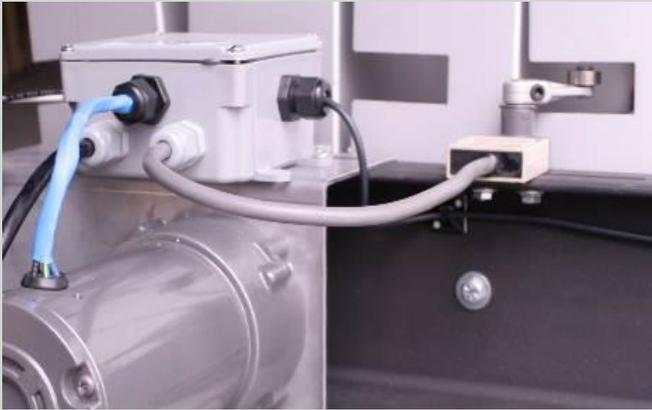
Le principe du bac et de la chaîne est robuste et totalement fiable. Un interrupteur de fin de course mécanique compte un sac à la fois, signalant au contrôleur de lots, qui arrête le distributeur lorsque le nombre correct de bacs est écoulé.
