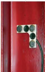
Les **cellules de charge** peuvent être utilisées lorsqu'une précision de 0,1 % est requise.
